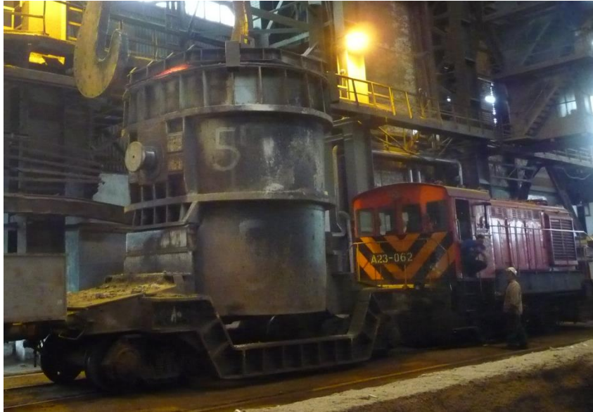
5. ábra A konverterben egyszerre gyártott ~135 tonna acél (1 adag)
