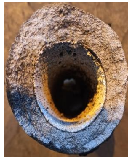
28. ábra Használt merülőcső keresztmetszete
