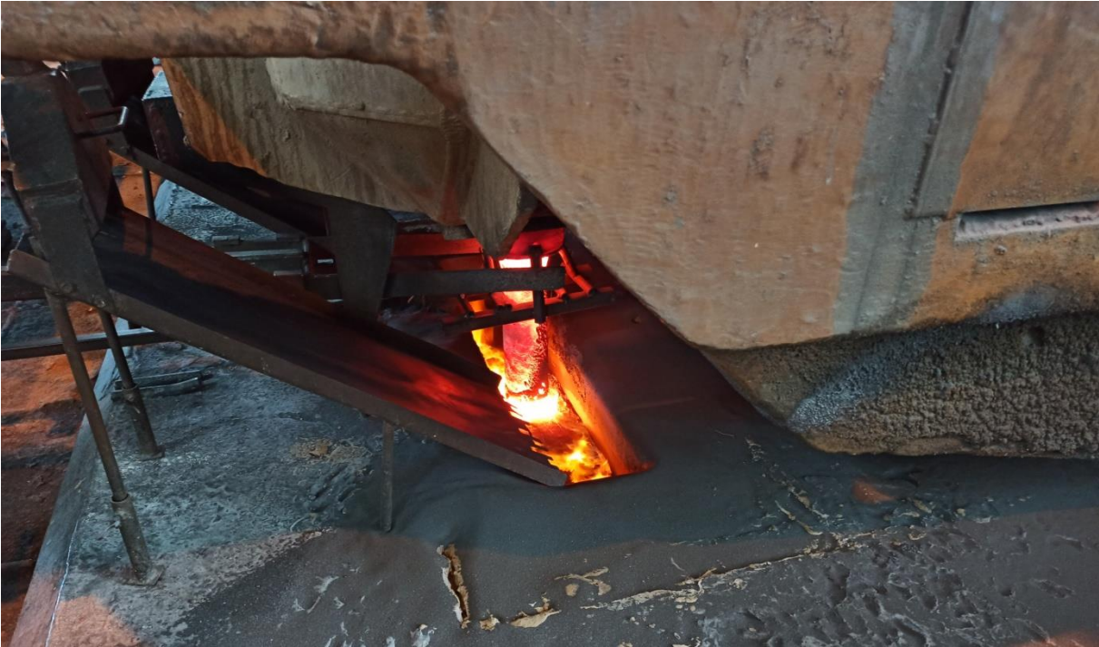
17. ábra Öntőpor adagolása a kristályosítói acélfelszínre
