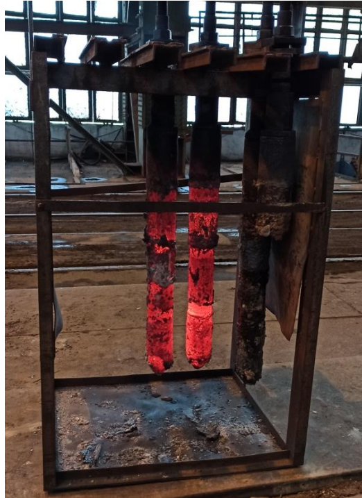
13. ábra Kristályosítói acélszint szabályzó közbensőüst dugók (használt)
